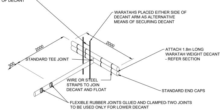
SCHEMATIC - DECANT OUTLET <u>DECANT:</u> SIX EQUALLY SPACED ROWS OF 10mm DIAMETER HOLES AT 60mm SPACINGS ALONG THE FULL LENGTH OF THE DECANT PIPE
