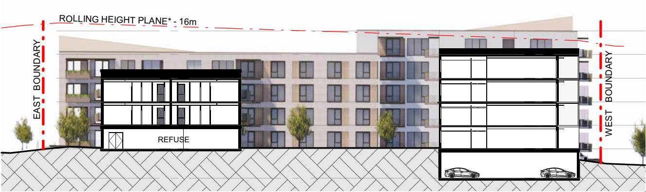
1 : 500 Section CM3 - CROSS SECTION 01
